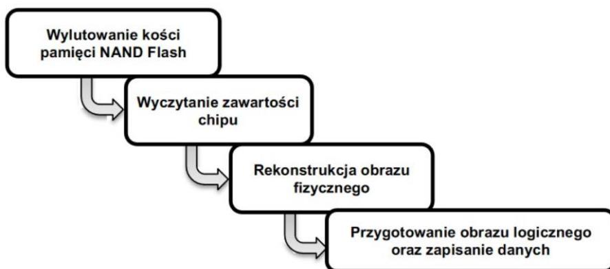
Rys. 1. Procedura odzyskiwania danych metodą Chip-off
